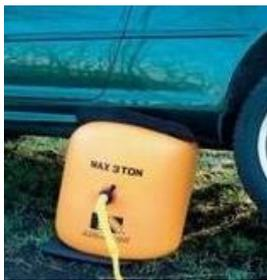
Le cric à coussin d'air en forme de ballon permet de soulever une masse de 3 tonnes. Il suffit de le brancher simplement à la sortie du pot d'échappement et faire fonctionner le moteur (au ralenti) pour envoyer les gaz d'échappement dans le coussin. Une soupape antiretour empêche les gaz de s'échapper.
