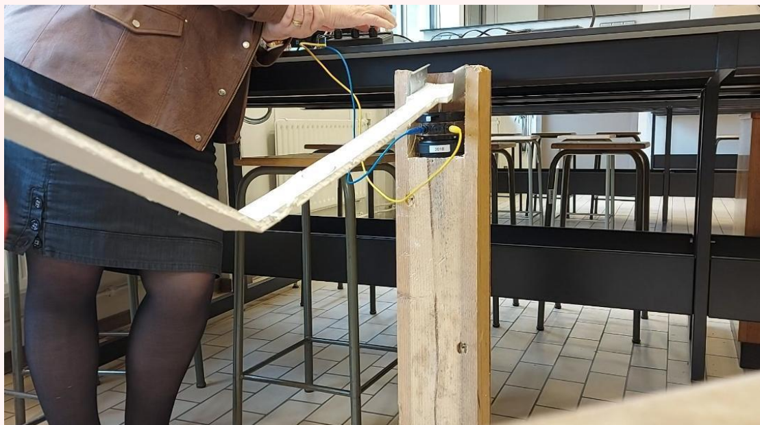
A la fréquence de résonance, l'oscillation du pont est maximale à l'endroit où se trouve le ventre de vibration. Si l'amplitude est suffisante, alors, il cède.
