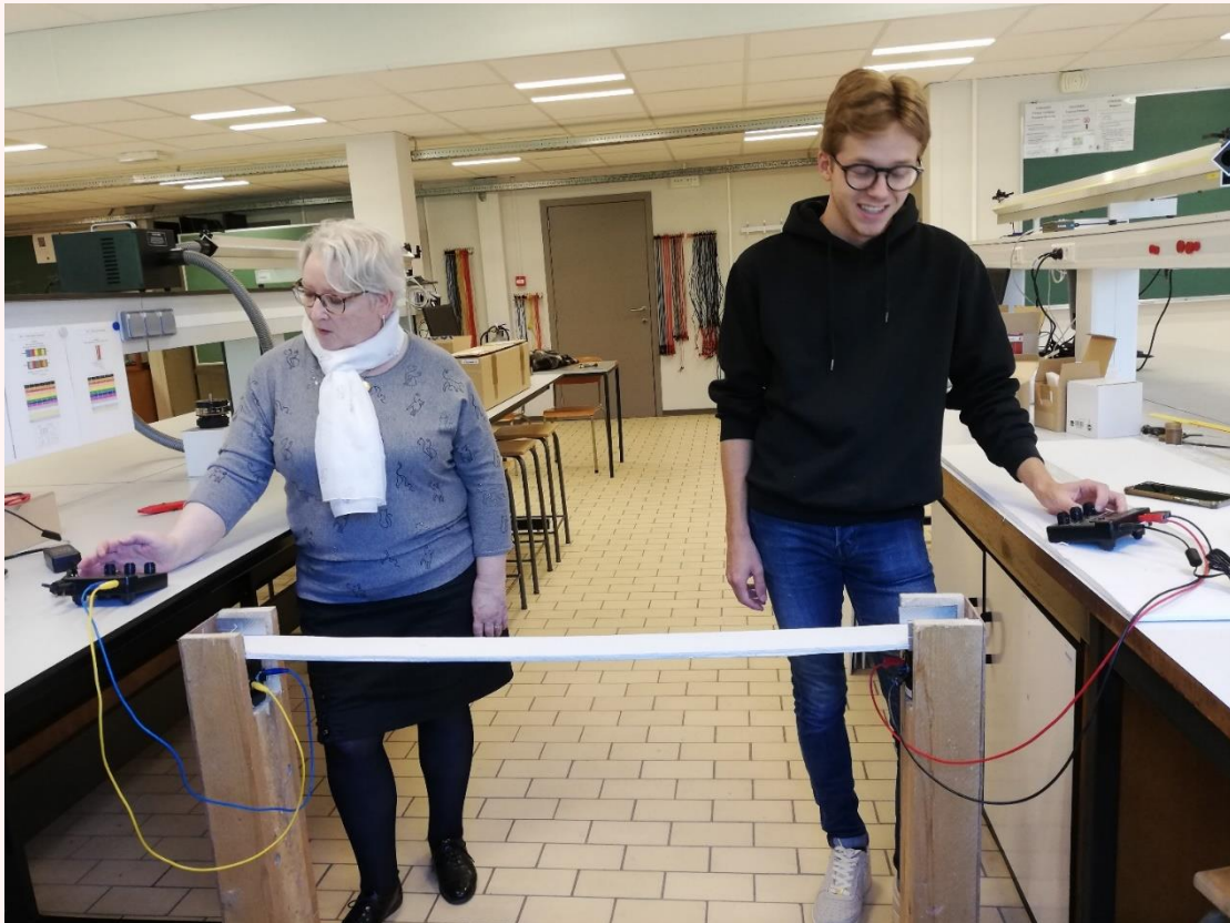
Photographie du dispositif. La plaque de plâtre est soutenue par deux encoches métalliques chacune fixée aux oscillateurs. Chaque oscillateur est relié à un générateur de fréquence.
