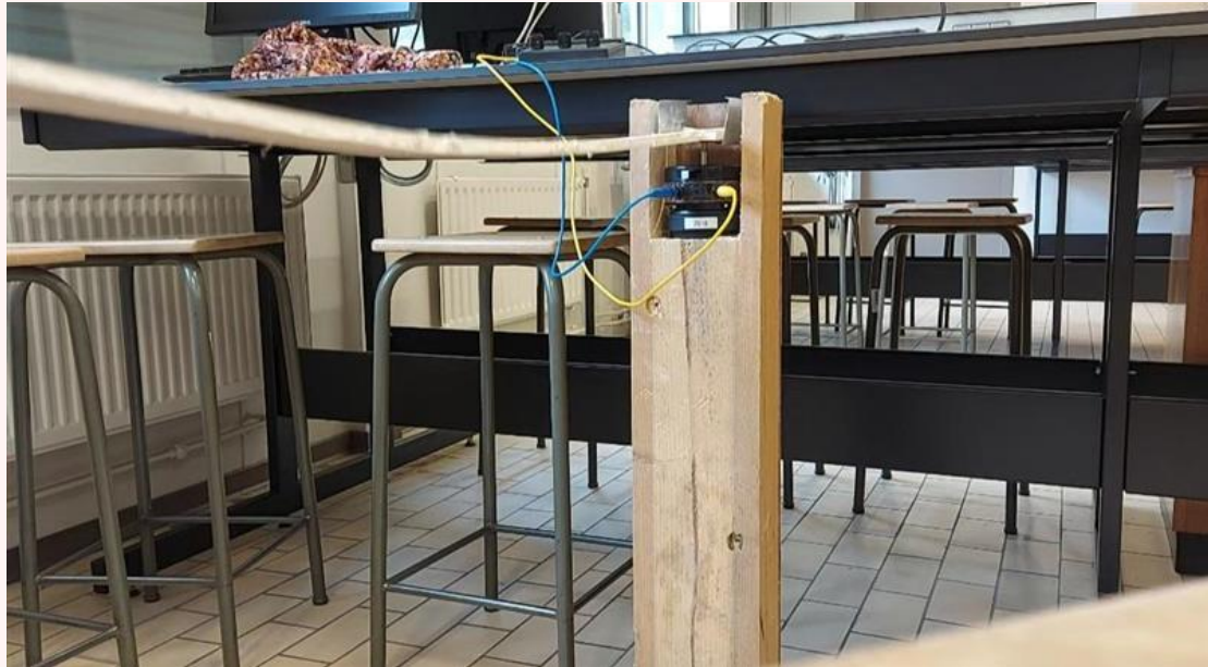
Photographie de l'oscillateur sur lequel est fixé une encoche métallique. Elle permet de soutenir la plaque de plâtre.
