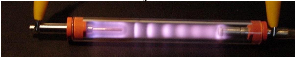
*Décharges stratifiées dans le tube à décharge; assez clairement visible ici.*
