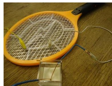
6. Déclencher plusieurs 2 ou 3 séries de décharges de 10 secondes avec 30 secondes de repos entre chaque série, observer le cercle foncé qui apparaît sur le tissu.
