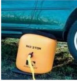
Le vérin à coussin d'air en forme de ballon permet de soulever une masse de 3 tonnes. Il suffit de le raccorder à l'échappement et de faire tourner le moteur (au point mort) pour évacuer les gaz d'échappement vers le coussin. Un clapet anti-retour empêche le gaz de s'échapper.
