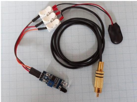
Capteur réflexe connecté avec des fiches, connexion batterie et câble blindé avec fiche RCA vers carte son.
