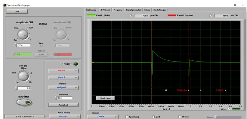
Le signal enregistré, réalisé avec l'oscilloscope de la carte son «Scope» ; les signaux de commutation ont été générés par deux écouteurs auriculaires.
