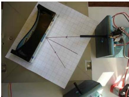
Placer ensuite un miroir obliquement devant le faisceau IR. Celui-ci est réfléchi. On peut alors, en déplaçant le phototransistor, retrouver la trace du rayon réfléchi et constater que l'angle de réflexion est égal à l'angle d'incidence.
