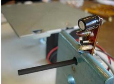
Un circuit électronique émetteur d'ondes IR, (voir schéma ci-dessous) alimenté par une pile de 9 V. (On peut fixer devant la diode émettrice un petit tuyau permettant d'orienter plus facilement le faisceau et éviter la dispersion du faisceau )
