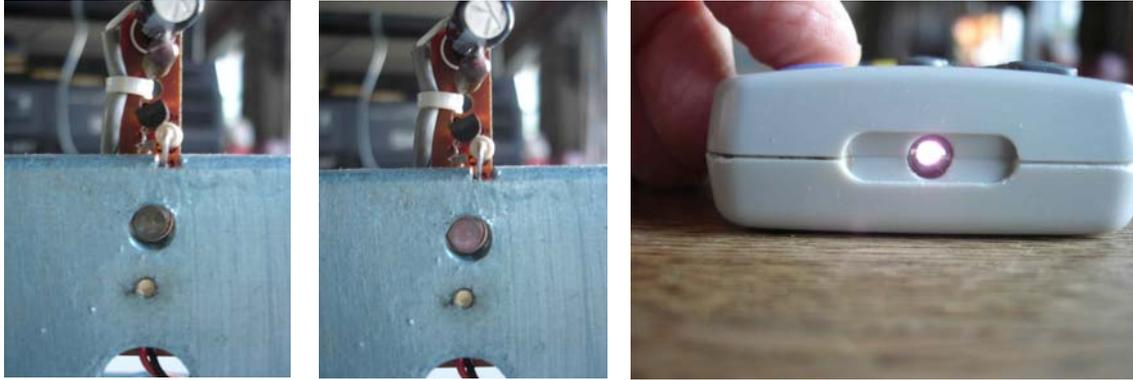
Vérifier à l'aide de l'appareil photo numérique que la diode émet des ondes IR. En pointant l'appareil vers la photodiode, on voit le faisceau: on a l'impression que la diode donne de la lumière rose. (Comparez avec la diode d'une télécommande)
