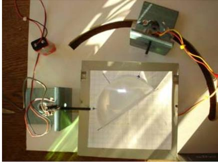
On peut aussi montrer que les rayons parallèles, convergent vers le foyer d'une lentille convergente, etc.... (Dessiner la lentille sur du papier, repérer les rayons; ensuite, déplacer le papier avec la lentille de telle sorte que le nouveau rayon soit parallèle au précédent...)
