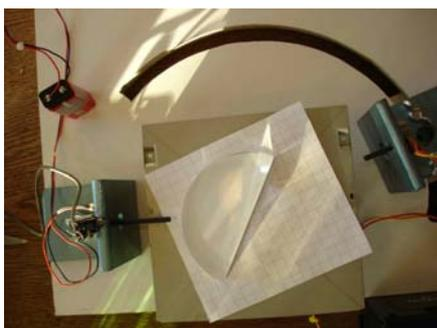
En retournant la lentille et en envoyant un rayon IR sous une incidence supérieure à l'angle limite, on constate qu'il y a réflexion totale.
