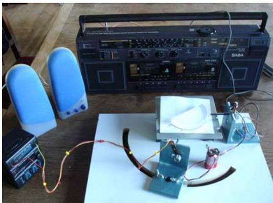
Brancher le circuit émetteur à la sortie audio du poste de radio, pour lequel on a, au préalable choisi une station émettrice. Couper le son de la radio.
