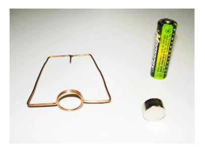
Faites, au milieu du fil conducteur, autour de la pile une boucle d'un tour et demi. Puis replier le fil comme on le voit sur la photo. Soudez les extrémités du fil de sorte à obtenir une pointe centrale. La hauteur du montage, entre le bout de la pointe et la boucle doit être égale à la hauteur de la pile additionnée de la moitié de la hauteur de l'aimant cylindrique
