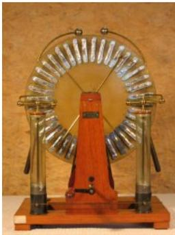
Ces machines s'améliorent et on voit apparaître des générateurs électrostatiques permettant de produire pendant une durée assez longue les charges électriques faisant fonctionner des appareils mettant en évidence d'autres phénomènes. Par exemple, nous avons la machine de Wimshurst ou celle de Van de Graaff.
