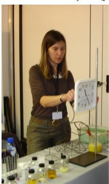
La pile "jus d'orange" est une cellule galvanique formée par la combinaison d'un ruban de magnésium, d'un ruban de cuivre et de jus dans un bêcher. Cela illustre le rôle de l'électrochimie dans la majorité des phénomènes entraînant le fonctionnement d'une horloge.
